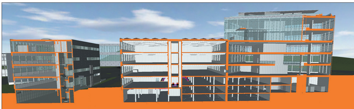
Seitenansicht des neuen Gebäudes mit drei Untergeschossen, einem Erdgeschoss und im rechten Teil des Baus mit weiteren vier Geschossen.
