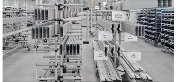
Vorkonfektionieren der Pfosten und Riegel
