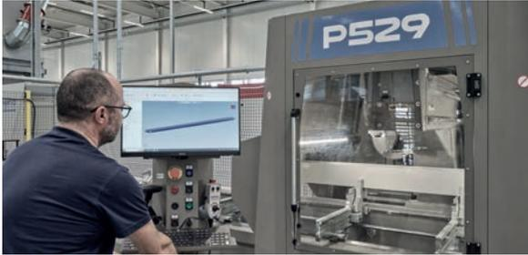
Bearbeiten der Pfosten-Riegel-Profile am 5-Achsen CNC Bearbeitungszentrum
